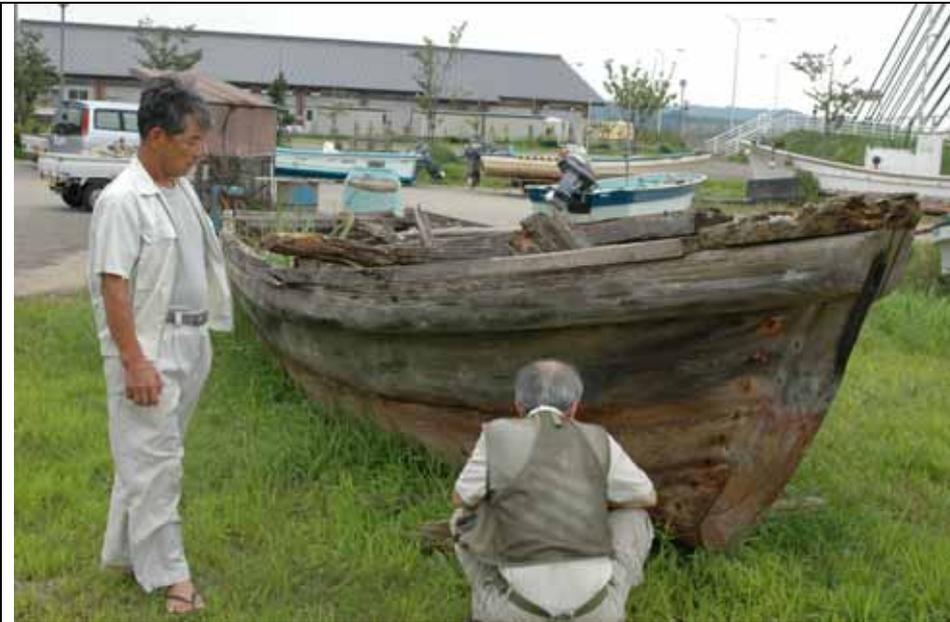
氷見市北大町に長らく放置されていた平底の木造船カンコ。風雨にさらされ、劣化が著しい。資料としての保存の方向性を探ったが、移動には船体がもたないだろう、と判断した。結局、実測図を作成し、写真による記録を行った後、解体して部材として保管することになった。その方法も議論の結果、船首部を切断し、形を保ったまま残すことになった。
