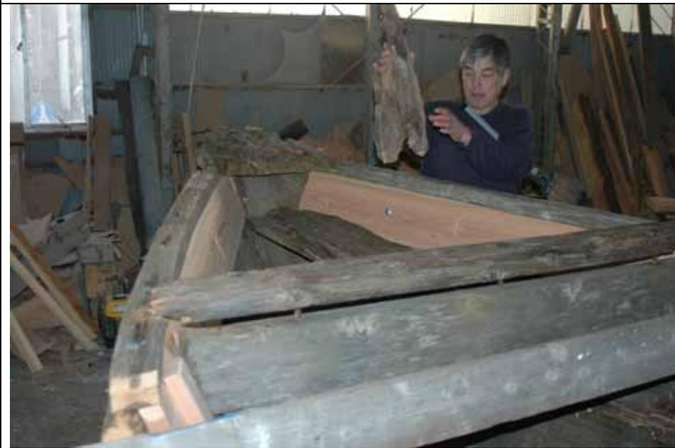
完成間近のカンコ船首部。切り離した船種部の補強を行った。劣化が著しい部材を一部置き換え、釘、ビスなどで締め直した。表面には撥水剤を塗布した。残りの部材は解体した状態で収集し、保管した。
