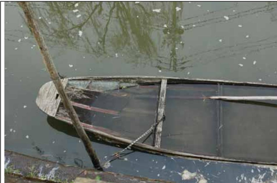
重要伝統的建造物群保存地区に選定されている佐原の町を流れる小野川に繋留されているサッパ舟。船首部のつくりが放生津瀉のイクリヤ、十二町瀉のタズルに似ている。こちらは平底の底板に 2 枚の棚板が付く五枚合わせの構造となる。
