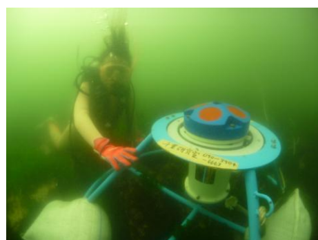
図7 人工リーフに ADCP を設置 (2012. 8. 3)
