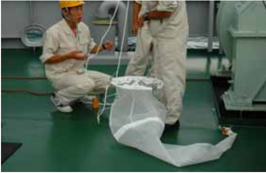
プランクトンネットにおもりをつけて船の後から、流す。スクリューを止めているが、スクリューにネットがからまないように操船には細心の注意が必要。
