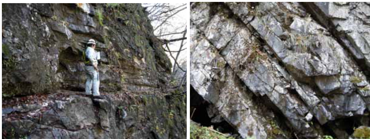
図 3．節理の産状．左) 石灰岩中の低角節理群．右) 流紋岩中の系統的節理群．
